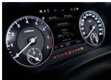
لوحة عدادات 7 TFT LCD بوصة
