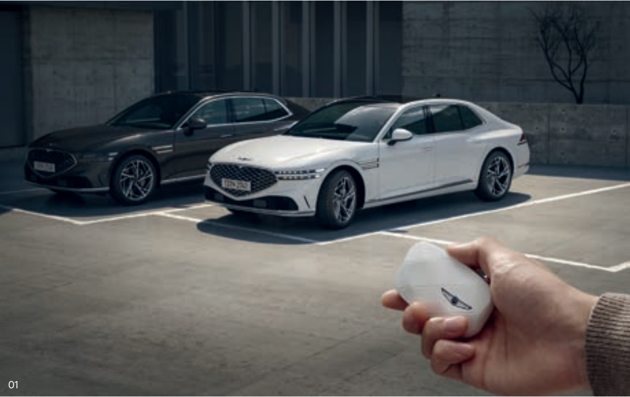
01. 원격 스마트 주차 보조(광각 카메라 기반 주차 및 사선 주차 포함) _ 차량 외부에서 원격으로 주차 및 출차를 할 수 있도록 도와줍니다. 주차선을 인식하여 직각 주차, 평행 주차, 사선 주차를 보조할 수 있습니다.
