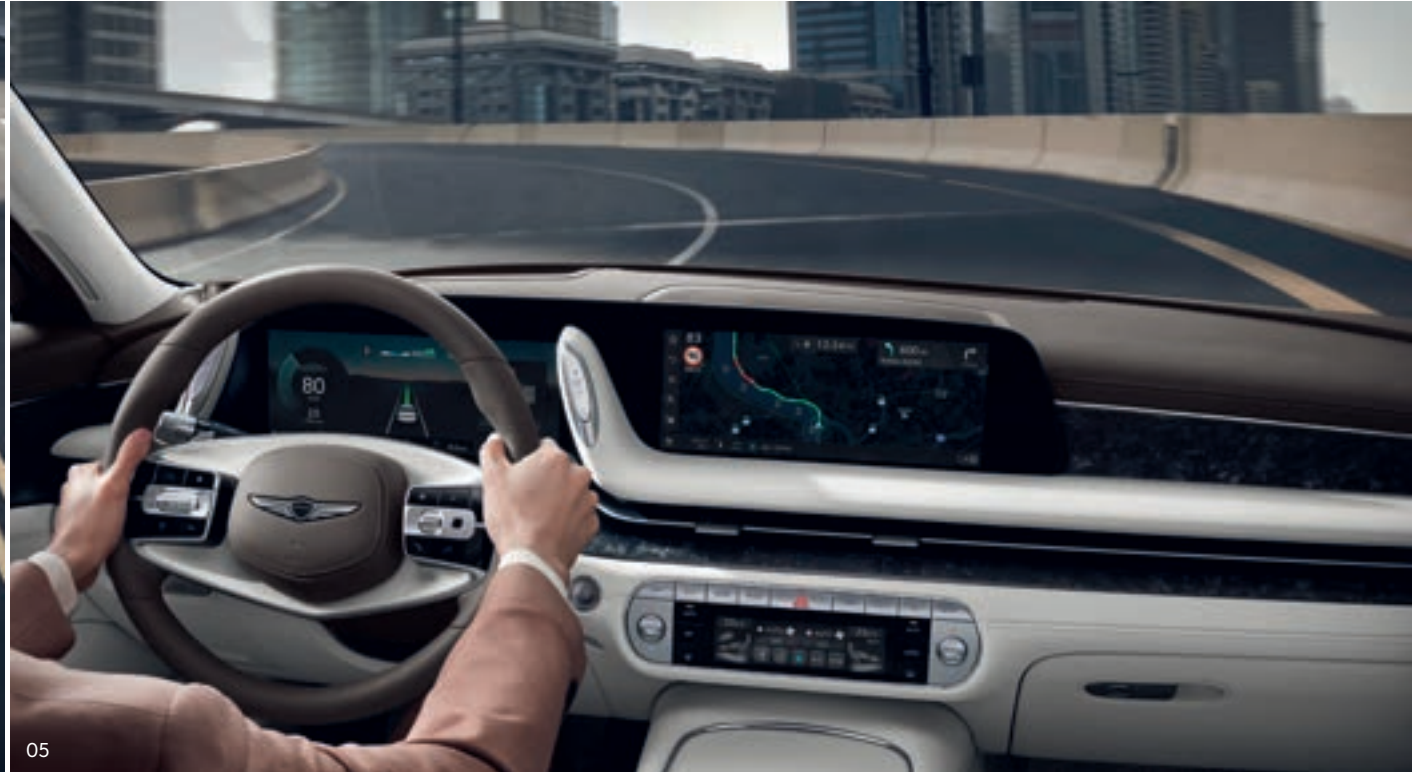
05. 내비게이션 기반 스마트 크루즈 컨트롤 _ 안전속도 구간이나 곡선 구간 진입 전에는 자동으로 감속하고 통과 시 원래의 설정 속도로 복귀합니다. 고속도로 진출입로에서도 속도를 적절히 조절해 안전한 주행을 돕습니다. 고속도로 주행 보조 2(차로 변경 보조 제어 기능 포함) _ 고속도로에서 앞차와의 간격을 유지하며 운전자가 설정한 속도로 곡선로에서도 차로 중앙을 유지하며 주행하고, 차로 변경을 보조하는 기능입니다.
