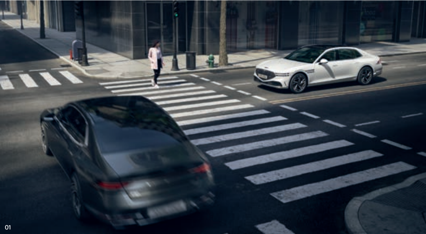
01. 전방 충돌방지 보조 _ 전방의 차량, 보행자, 자전거 탑승자와의 충돌이 예상되면 운전자에게 경고하고 필요시 제동을 도와줍니다. 교차로 좌회전 시에는 맞은편 전방에서 다가오는 차량, 직진 통과 시에는 좌우방향에서 다가오는 차를 인지해 경고 또는 긴급 제동을 보조합니다. 차로 변경 시 맞은편에서 다가오는 차량이나 옆 차로의 선행 차량, 차로 가장자리로 들어와 있는 보행자와의 충돌 위험을 예방합니다.
