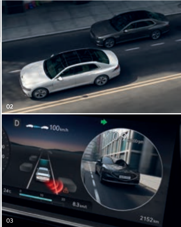
02. 후측방 충돌방지 보조 _ 차로 변경을 위해 방향지시등 스위치를 조작했을 때 후측방 차량과 충돌 위험이 감지되면 경고를 해줍니다. 경고 후에도 충돌 위험이 높아지면, 자동으로 차량을 제어하여 충돌 회피를 도와줍니다. 평행 주차상태에서 전진 출차 중 후측방 차량과의 충돌 위험이 감지되면 자동으로 제동을 도와줍니다.
