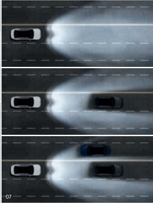
07. 지능형 헤드램프 _ 상시 상향등 주행으로 운전자의 전방 시야를 안전하게 확보하는 한편, 마주 오는 전방 차량 영역의 빛을 부분적으로 차단해 상대 운전자의 눈부심을 막아줍니다. 선행 차량 영역에도 동일하게 작동하며, 별도로 헤드램프를 조작할 필요가 없어 야간 운전이 수월해집니다.
