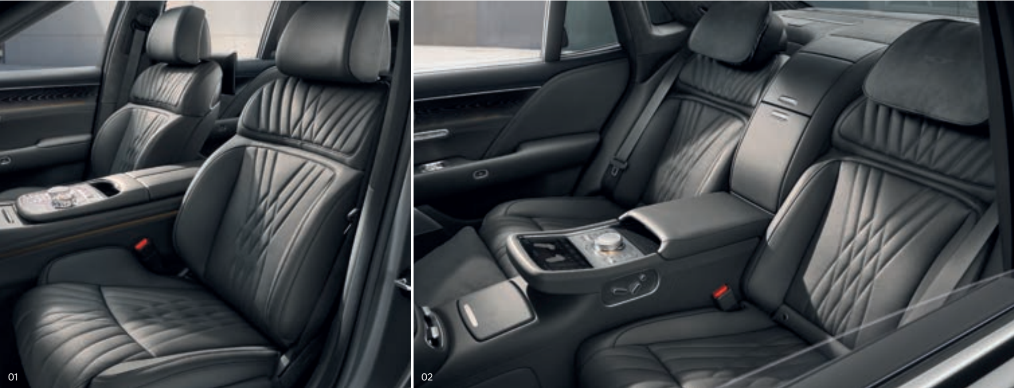
01. 에르고 릴렉싱 시트 _ 시트백 10개 포켓과 쿠션 2셀 구조를 활용하여 전신 모드 외 3가지의 마사지 모드를 제공합니다. 주행 속도나 뒷좌석 원스텝 특화 모드, 무드 큐레이터 등의 조건과 연동되는 공압시스템으로 최적의 착좌감을 제공합니다. 02. 퍼스트 클래스 VIP 시트 _ 좌우 독립, 슬라이딩 연동 리클라이닝이 가능한 뒷좌석 시트는 높침 각도와 틸트 거리를 최적화하고 레그레스트와 풋레스트의 연결형 구조를 적용해 장시간 운행 에도 안락한 착좌감을 선사합니다.
