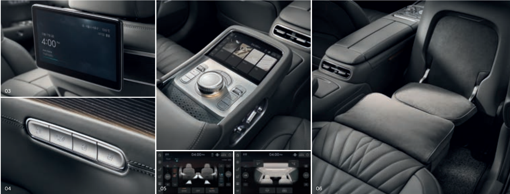
03. 04. 전동식 뒷좌석 듀얼 모니터 _ 터치 방식의 10.2인치 대화면 모니터는 좌우 승객이 독립적으로 사용할 수 있으며, 각도는 시트 모드에 따라 연동됩니다. 목적지까지의 경로와 남은 시간 등도 표시해줍니다. 05. 8인치 뒷좌석 암레스트 터치 디스플레이 _ 뒷좌석 탑승객이 암레스트에 위치한 터치 디스플레이를 통해 공조, 시트, 마사지, 커튼, 조명 등을 직접 설정할 수 있습니다. 정보를 직관적으로 파악할 수 있도록 실제 차의 이미지나 애니메이션으로 화면을 구성해 조작이 쉽습니다. 06. 레그레스트 & 풋레스트 _ 연결형 구조의 레그레스트와 풋레스트가 더욱 편안한 착좌감을 제공합니다. 마사지 기능과 열선/통풍 기능이 적용된 풋레스트는 사계절 내내 쾌적한 온도에서 발의 피로를 풀어 줍니다.
