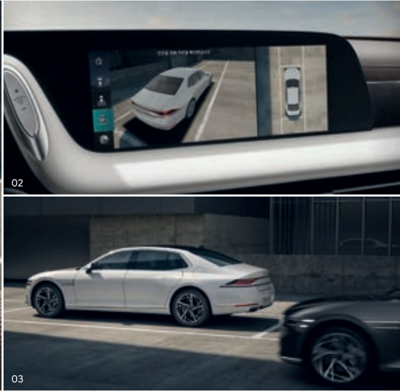
02. 서라운드 뷰 모니터 _ 안전한 주차를 위해 차량 주변 상황을 영상으로 보여줍니다. 03. 안전 하차 보조 _ 정차 후 탑승자가 차에서 내리려고 도어를 열 때 후측방에서 접근하는 차량을 인식하면 경고를 해주며, 전자식 차일드 락을 잠금 상태로 유지해 도어가 열리지 않도록 도와줍니다. 또한 후측방 충돌 위험이 판단되면 도어 열림 버튼을 눌러도 도어가 열리는 것을 방지합니다.
