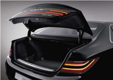
Электропривод крышки багажника с системой автоматического открывания
