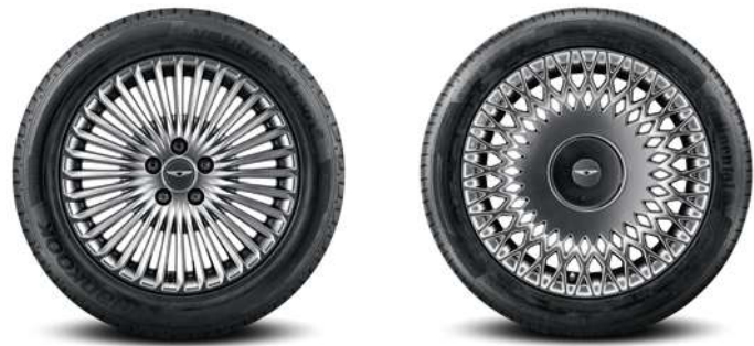
Шины Michelin 245/50R18 и 18-дюймовые многоспицевые диски Шины Continental 245/45R19 (передние) и 275/40R19 (задние) и 19-дюймовые диски в дизайне концепта G-Matrix
