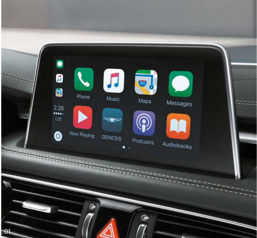
01. Apple CarPlay* _ Позволяет подключаться к информационно-развлекательной системе автомобиля и обеспечивает доступ к навигации и музыкальному контенту смартфона. Чтобы водитель не отвлекался от дороги, предусмотрено управление с помощью голосовых команд или посредством тачскрина.
