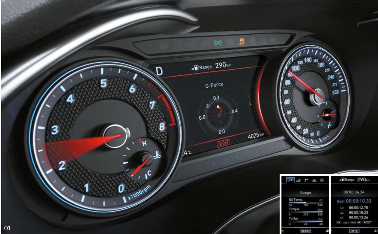
01. Приборная панель с 7-дюймовым LCD-дисплеем _ На дисплее отображаются температура масла в двигателе, крутящий момент, показания датчика турбонаддува, время разгона (лучшее время разгона и 3 последних значения), перегрузку (текущие значения перегрузки на крыше автомобиля, под автомобилем, справа, слева). Удобный доступ к полезной информации помогает сделать вождение ещё более приятным.
