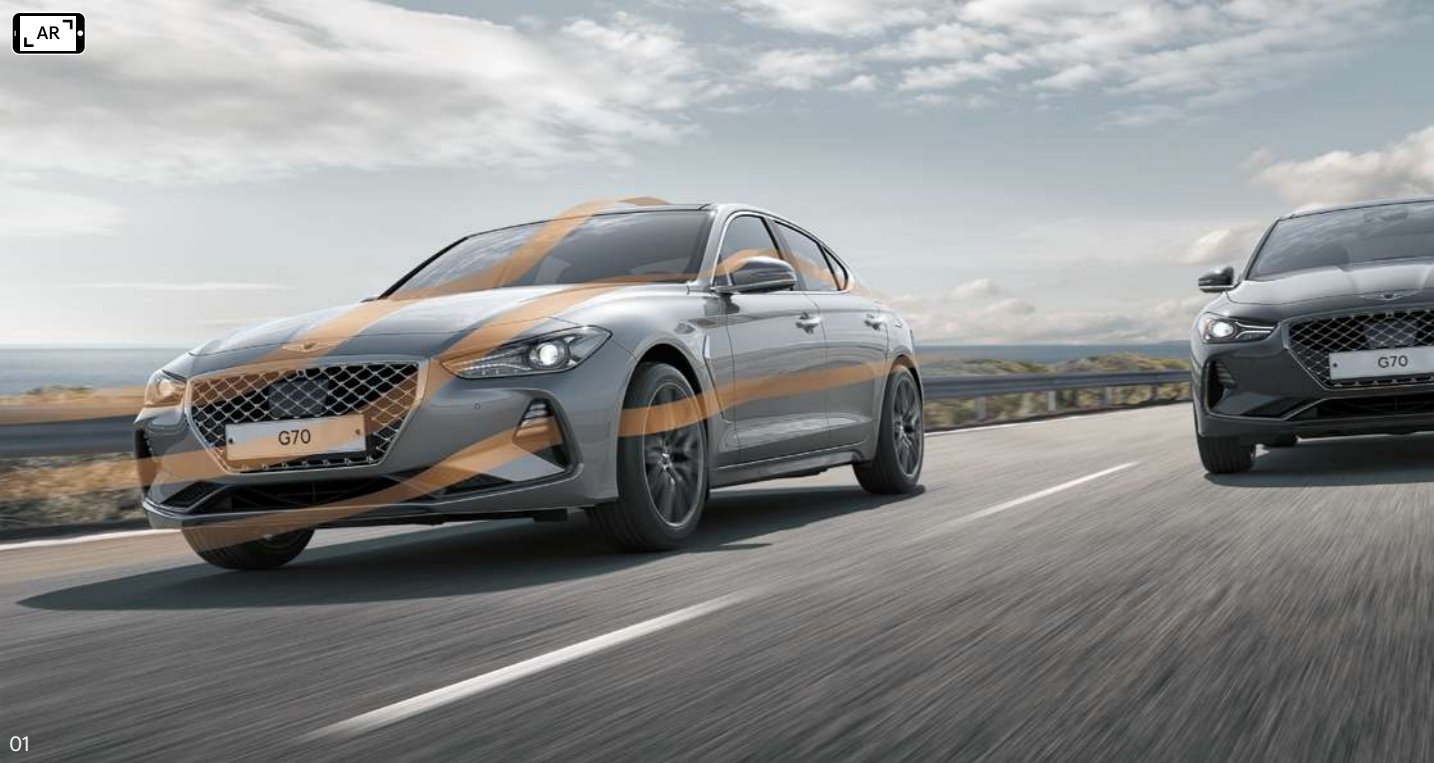
01. Аэродинамика _ Дорожный просвет, высота автомобиля, угол наклона заднего стекла, положение багажника выверены с идеальной точностью. Кроме того, на нижнюю часть корпуса установлена защита. Это позволяет минимизировать сопротивление воздуха и обеспечивает превосходные аэродинамические характеристики (коэффициент сопротивления воздуха CD составляет 0,28).
