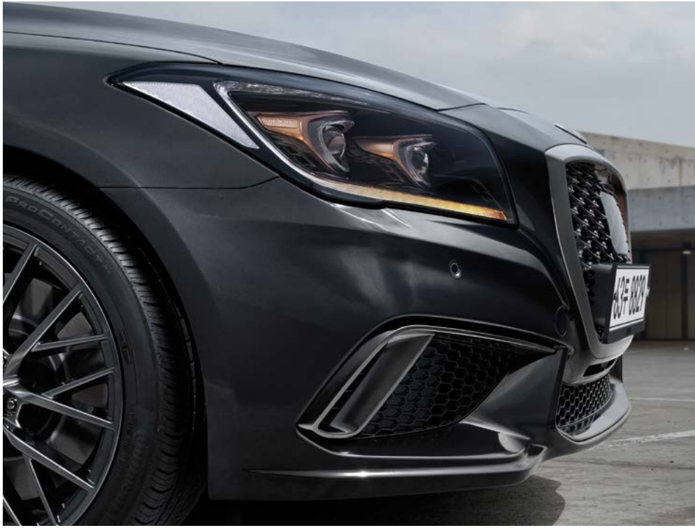
시퀀셜 방향지시등 & 어댑티브 Full LED 헤드램프 _ 순차적으로 점등되는 방향지시등과 코퍼 크롬 디테일의 헤드램프를 적용하였습니다. 램프 하단의 버티컬 타입 에어커튼은 공력 및 제동계 냉각 성능을 향상시킵니다.
