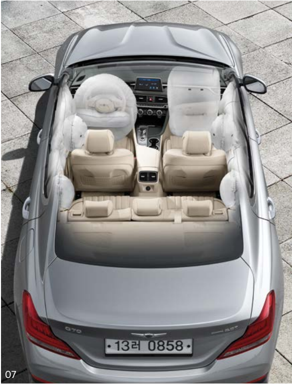
07. 9 에어백 시스템 _ 운전석/동승석에는 탑승자의 위치와 체중, 충돌 정도에 따라 팽창 정도와 시점을 제어해주는 어드밴스드 에어백을 적용하였습니다. 운전석 무릎 에어백, 앞/뒤 사이드 에어백과 전복 대응 커튼 에어백까지 총 9개의 에어백으로 상해를 최소화합니다.
