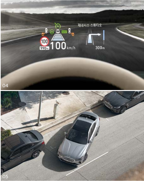
04 & 05. 헤드업 디스플레이 _ 차량 정보를 8인치 이상의 영상 사이즈로 전면 윈드실드에 표시하며, 최적화된 밝기로 주간 시인성도 뛰어납니다. 주차 거리 경고(전방/후방) _ 주차 시에 차량 전방과 후방에 장착된 센서가 장애물과의 거리를 감지하여 경고음을 내보내며, 클러스터에도 경고표시를 띄워 주차를 도와줍니다.
