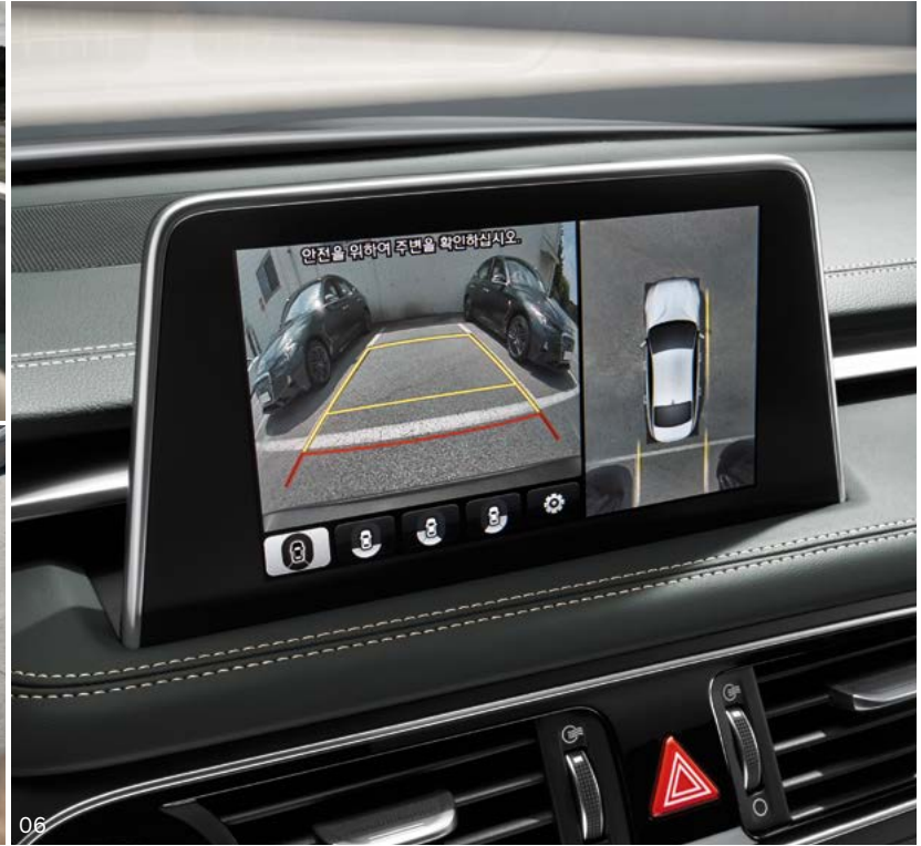
06. 서라운드 뷰 모니터 _ 4대의 HD급 카메라가 전/측/후방에 장착되어 차량의 주변 상황을 실시간으로 제공합니다. 전/후방 장애물 근접 경고 표시, 후진 시 예상궤적 표시와 주행 중 후방영상 표시 기능을 갖추었습니다.
