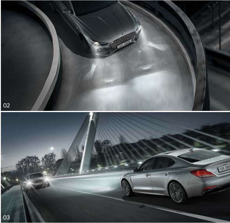
02. 로우빔 보조(조향연동) _ 야간 주행 시 스티어링 휠의 조향에 따라서 헤드램프가 좌우로 자동 조절되어 보다 효과적으로 시야를 확보하고 사각지대를 최소화합니다. 03. 하이빔 보조 _ 야간 주행 시 마주 오는 차량의 전조등 불빛 및 주변 조도를 감지하여 헤드램프를 상향등에서 하향등으로 자동 전환시킴으로써 운전 차량 및 상대 차량이 보다 안전하게 주행할 수 있도록 보조합니다.
