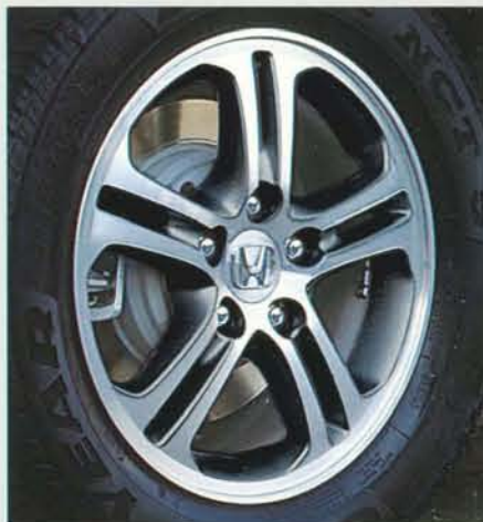
Llanta de aleación. De aluminio pulido de 16", en dos tonos y diseño especial.
