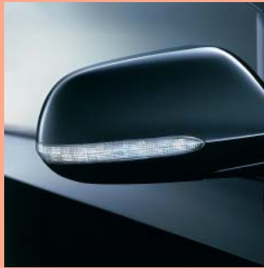
Blinker – Die in die Seitenspiegel integrierten Blinker sind für andere Fahrer besser zu sehen.
