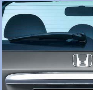
Heckscheibenwischer – Wenn Sie die Frontscheibenwischer eingeschaltet haben, startet der Heckscheibenwischer automatisch, sobald Sie den Rückwärtsgang einlegen.
