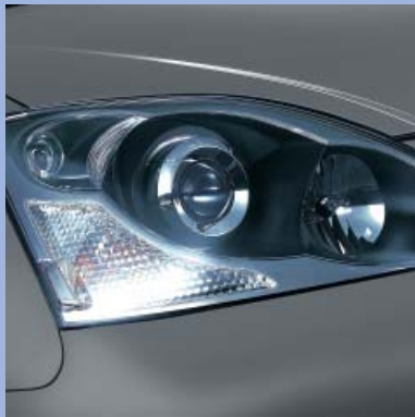
Frontscheinwerfer – Frontscheinwerfer mit Projektionstechnik werfen mehr Licht noch weiter als übliche Scheinwerfer und verbessern so die Sicht (ab LS-Version).
