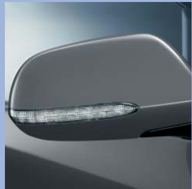
Blinker – Die in die Seitenspiegel integrierten Blinker sind für andere Fahrer besser zu sehen (ab LS-Version).
