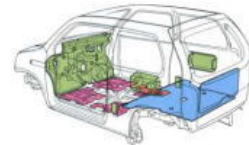
制振材・遮音材配置図
