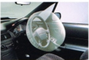
●運転席用SRSエアバッグシステム エアバッグ膨張時の写真を合成
