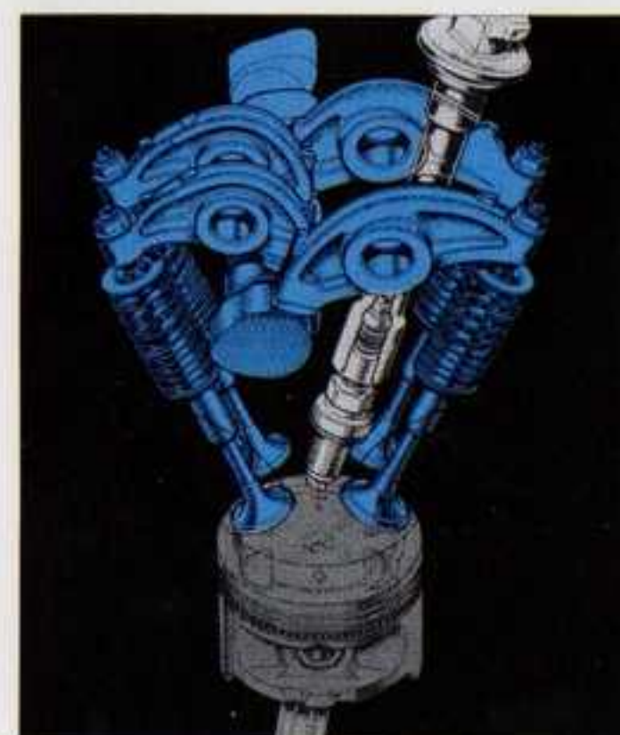
Culasse avec bougies en position centrale
