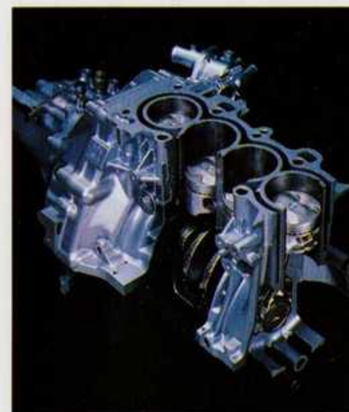
Bloc cylindre en alliage d'aluminium rigide et léger
