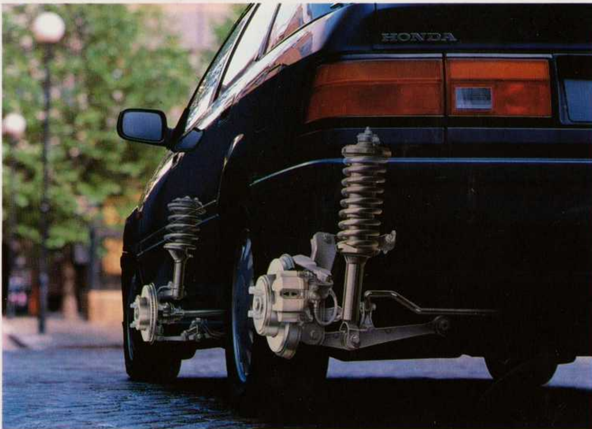
Quatre freins à disque dont 2 ventilés à l'avant en série sur nouvelle CONCERTO 1.6i et 1.6i 16
