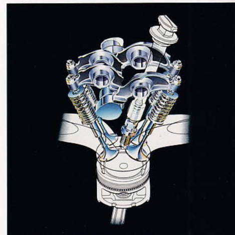
Eine obenliegende Nockenwelle für vier Ventile pro Zylinder.
