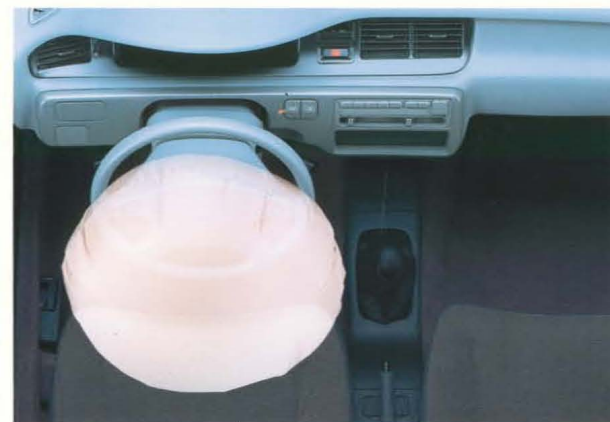
Simulacro de colisión en el laboratorio poniendo en funcionamiento el sistema SRS Airbag
