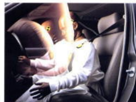
写真は、シートベルト・プリテンショナー（新案）とSRSエアバッグシステム（新案）の展開状態を示しています。
