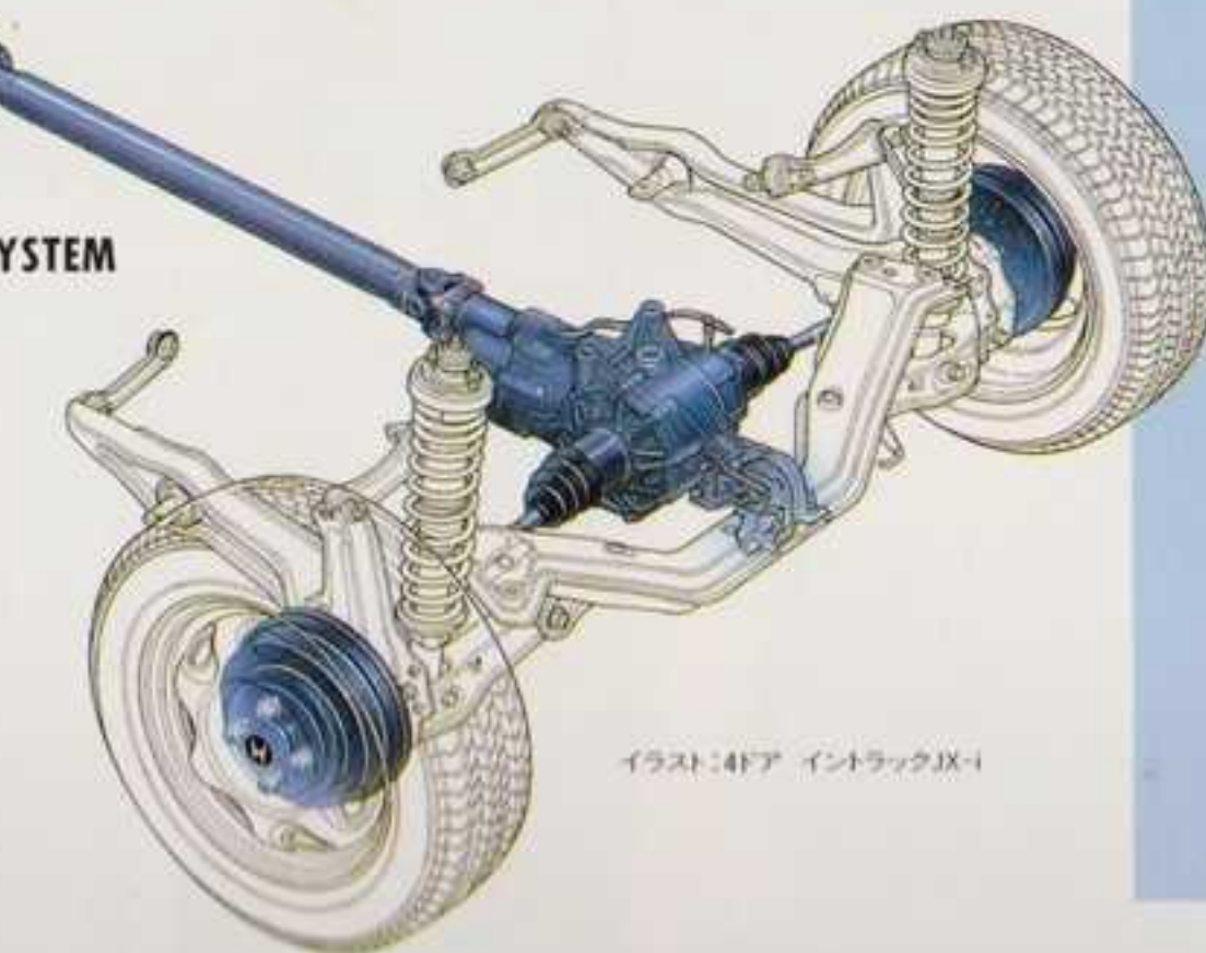
イラスト：左・右トルクスプリット型V.C. +ドグクラッチ構造図
