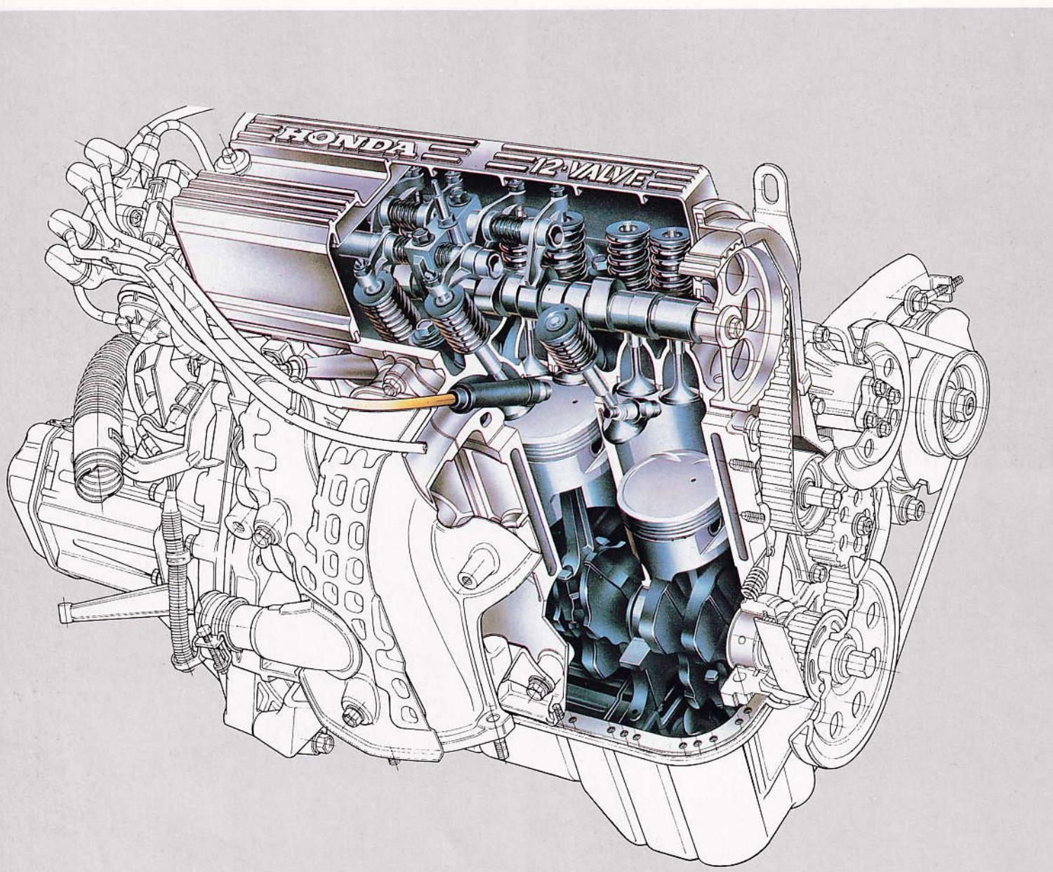
Was nutzt die schönste Karosserie, wenn die Technik nicht auf dem neuesten Stand ist. Der 12-Ventil-Motor des Honda Accord ist eine Neuentwicklung, bei der drei Ventile pro Zylinder (2 Einlaß- und 1 Auslaßventil) für optimale Kraftstoffausnutzung und wirtschaftliches Fahren sorgen.
