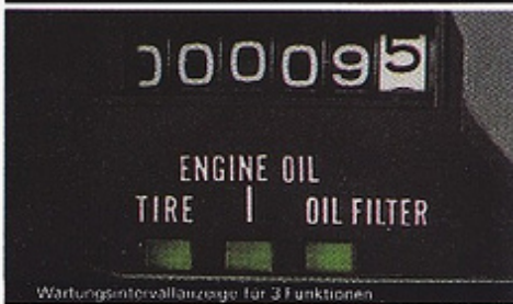
Wartungsintervallanzeige für 3 Funktionen
