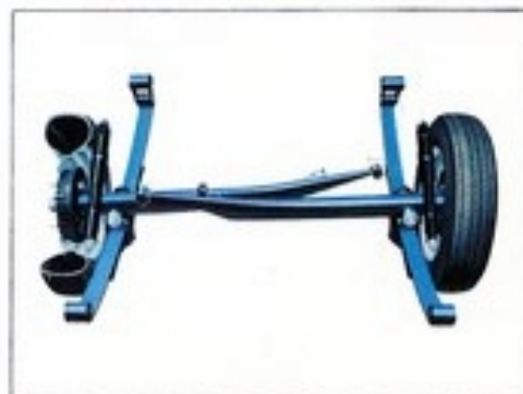
●後輪クロスビーム式独立懸架とフローティングジョイント
