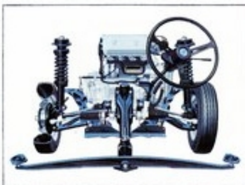
●前輪マックファーソン式独立懸架とユニークなマウント部
