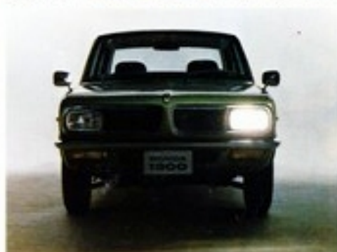
●ヘッドライト回路は安全な左右独立回路
