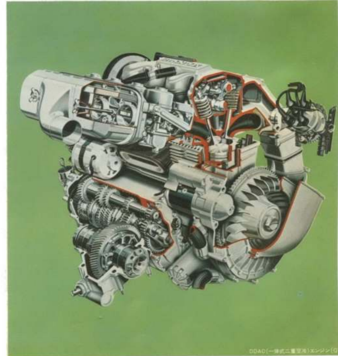
DDAC(一体式二重空冷)エンジン(GT.L)
