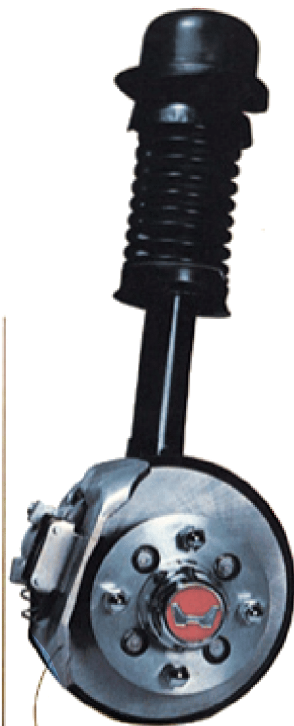
前輪ディスクブレーキ。ディスクをくわえるキ ャーを前部に配置。脱熱効果は万点。
