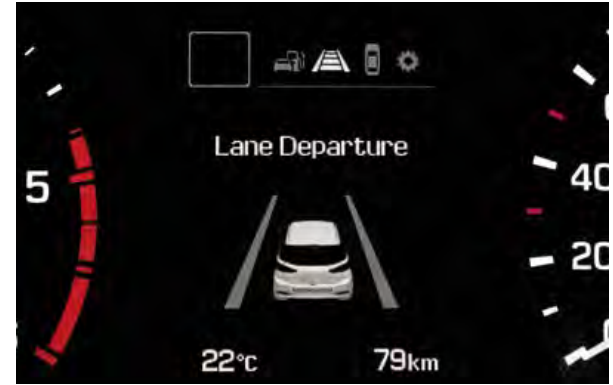
Spurhaltewarnsystem. Gibt zuerst ein optisches, dann ein akustisches Warnsignal beim Spurwechsel ohne Blinkerbetätigung.
