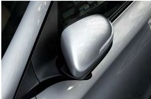
Elektrisch anklappbare Außenspiegel. Die Außenspiegel können elektrisch zur Tür hin eingeklappt werden. Sehr nützlich, wenn es beim Parken einmal eng wird.
