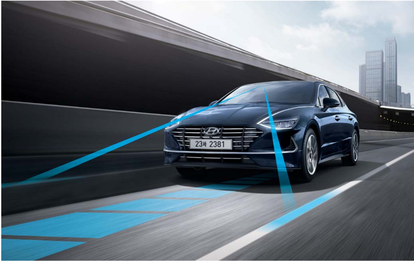
차로 유지 보조 전방 카메라를 이용해 차선을 인식하고 차선의 가운데로 차량이 주행할 수 있도록 보조해줍니다. 필요시 자동으로 스티어링 휠 제어를 통해 차로 이탈 방지를 보조해줍니다.
