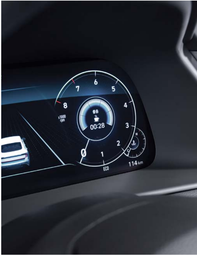
운전자 주의 경고 / 전방 차량 출발 알림 차량이 스스로 운전자의 주행 패턴과 차로 내 차량 위치 등을 종합적으로 분석하여 운전자의 피로도나 부주의 운전이 감지될 경우, 팝업 메시지와 경고음을 통해 휴식을 권유합니다. 또한 정차된 상태에서 전방 차량이 출발하면 클러스터를 통해 운전자에게 알림을 제공합니다.
