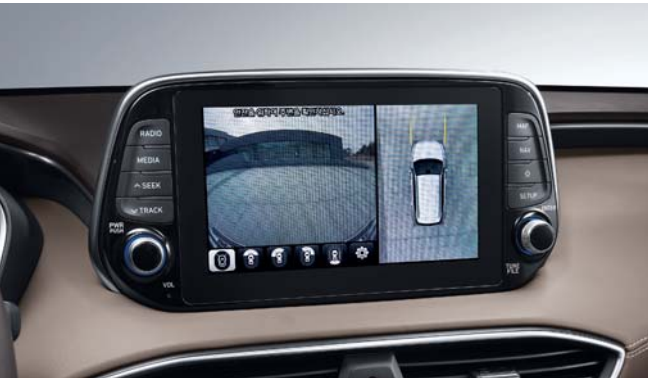
후방모니터 (DRM) 뒷좌석 승차인원 또는 화물 등으로 룸미러 시야확보가 불가능 할 때, 차량 후방 영상을 실시간으로 보여주어 후방 상황을 인지하도록 도와줍니다. 서라운드 뷰 모니터 4대의 고화질 카메라가 전·후·측면의 사각지대를 보여주어 운전자가 안전하게 주차할 수 있습니다. 세차장 진입 보조 모드는 일상 생활에 편리함을 더해 줍니다.
