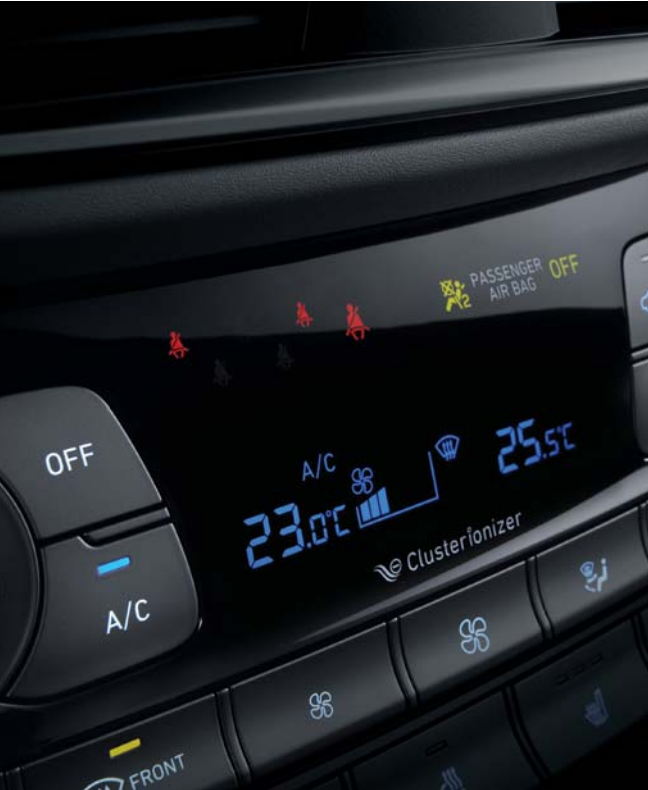
전좌석 시트 벨트 리마인더 1열 뿐만 아니라 후석 승객의 안전벨트 착용 여부까지 감지하여, 안전벨트를 착용하지 않을 경우 경고등 또는 경고음으로 안내해 줍니다.
