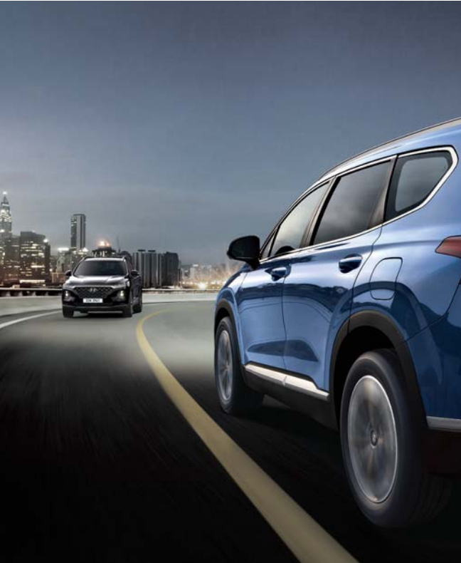
하이빔 보조 야간에 상향등을 켜고 주행하는 중 맞은편 또는 앞쪽에 차량이 있을 경우 헤드램프를 하향등으로 전환하여 잦은 상향등 조작에 따른 불편함을 줄여주고 운전자량 및 상대차량이 안전하게 주행할 수 있도록 도와줍니다.
