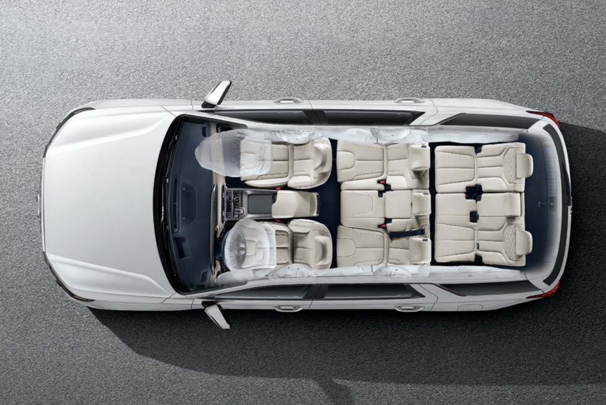
9 에어백 시스템 1열부터 3열 승객을 보호해 주는 커튼 에어백을 비롯하여, 운전석/동승석 에어백과 1열/2열 사이드 에어백 그리고 운전석 무릎 에어백까지 총 9개의 에어백이 적용되었습니다.
