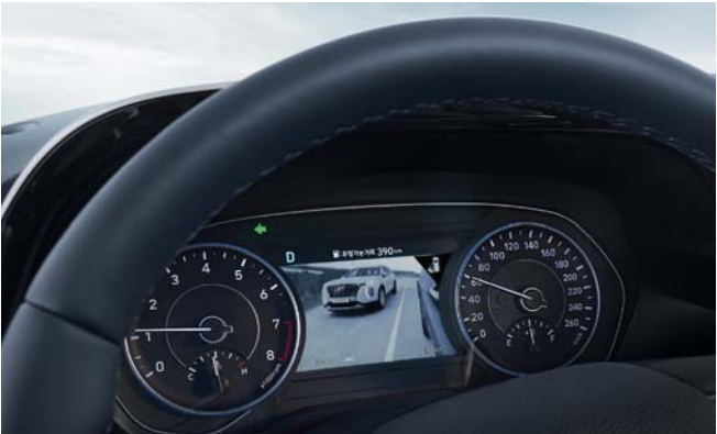
운전자 주의 경고 차량이 스스로 운전자의 주행 패턴과 차로 내 차량 위치 등을 종합적으로 분석하여 운전자의 피로도나 부주의 운전이 감지될 경우, 팝업메시지와 경고음을 통해 휴식을 권유합니다.
