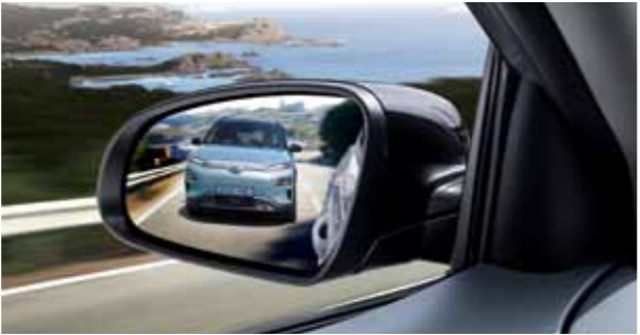
후측방 충돌 경고 (현대 스마트센스 패키지 옵션 선택 필요) 아웃사이드 미러로 확인할 수 없는 사각지대에 있는 차량 또는 옆 차선에서 고속으로 접근하는 차량을 인지하여 운전자에게 경고를 줌으로써 차선변경 시 충돌사고를 예방합니다.
