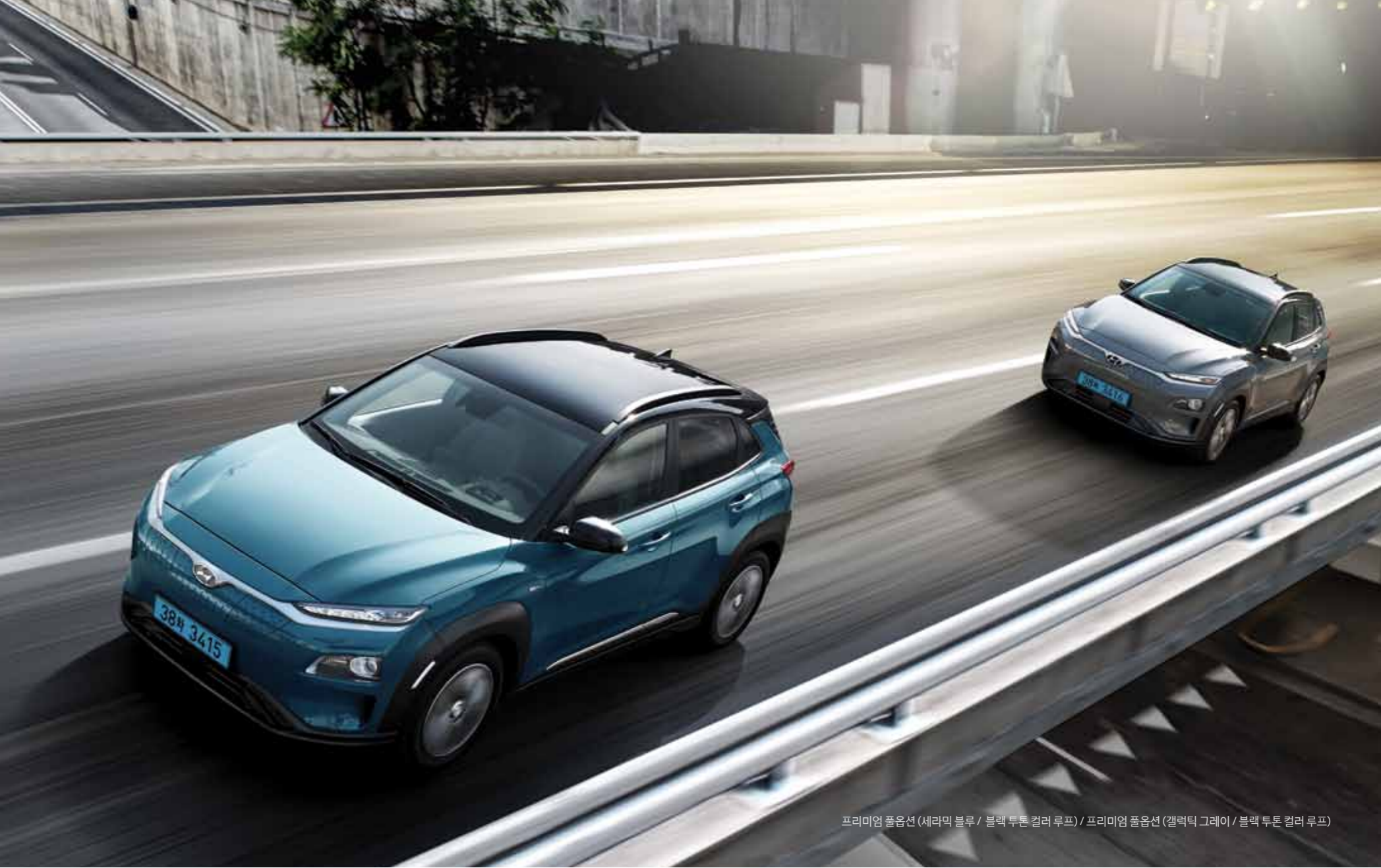
차로 유지 보조 (현대 스마트센스 패키지 옵션 선택 필요) 일반 도로에서 전방카메라 / 레이더를 활용, 차로 내 주행을 유지하고 차간 거리를 제어하여 주행을 보조합니다.
