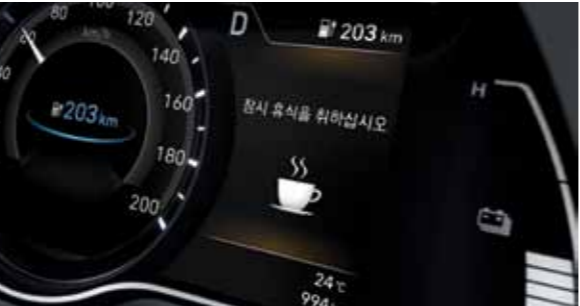
운전자 주의 경고 (전 트림 기본 적용) 운전 상태를 5단계로 표시하며, 운전자의 피로나 부주의한 운전 패턴으로 판단되면 팝업 메시지와 경고음을 통해 휴식을 유도합니다.
