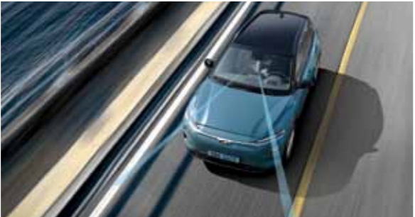
차로 이탈방지 보조 / 차로 이탈 경고 (전 트림 기본 적용) 전방 감지 카메라를 이용해 차선을 인식하고 방향지시등 조작 없이 차량이 차선을 이탈하려 할 경우, 스티어링 휠을 제어 또는 경고하여 차로 이탈을 방지해줍니다.
