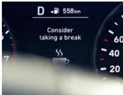
Aufmerksamkeitsassistent: Erkennt anhand des Lenk- und Bremsverhaltens sowie der Fahrdauer beginnenden Konzentrationsverlust und sendet akustische und visuelle Warnhinweise.
