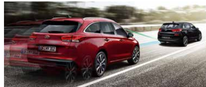
Autonomer Notbremsassistent inklusive Frontkollisionswarner und Fußgängererkennung (FCA): Das FCA-System überwacht mit Kamera und Radarsensor den vorausfahrenden Verkehr. Stellt der Notbremsassistent fest, dass eine Gefährdung durch andere Fahrzeuge (8-180 km/h) oder für Fußgänger (bis 64 km/h) besteht, löst er zunächst eine optische und akustische Warnung aus und leitet im Notfall eine Teil- oder Vollbremsung ein, sofern Sie die Bremse nicht bereits selbst betätigt haben.
