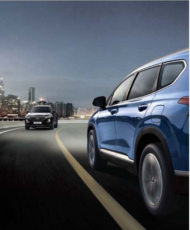
하이빔 보조 야간에 상황등을 켜고 주행하는 중 맞은편 또는 앞쪽에 차량이 있을 경우 헤드램프를 하향등으로 전환하여 잦은 상황등 조작에 따른 불편함을 줄여주고 운전차량 및 상대 차량이 안전하게 주행할 수 있도록 도와줍니다.
