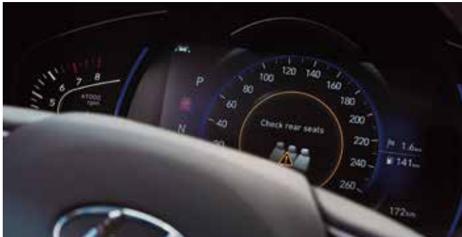
Der Insassenalarm wird ausgelöst, wenn durch das Sensorsystem unbemerkt Passagiere oder Tiere auf den hinteren Sitzplätzen beim Verlassen des Fahrzeugs registriert werden.
