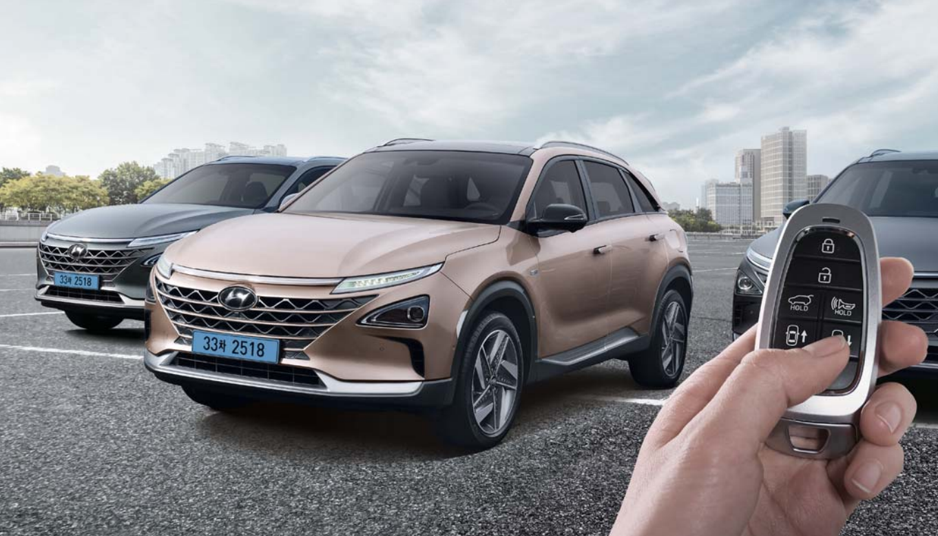
원격 스마트 주차 보조 주차 보조 기능을 활성화 한 후 주차공간을 발견하게 되면 차량 내 안내에 따라 하차한 다음, 스마트키의 작동 버튼을 누르고만 있으면 차가 스스로 주차합니다. 직각주차 및 평행주차 모두 가능하며, 운전자 탑승 시에도 차량 내부의 작동 버튼을 누르고 있으면 자동 주차 보조를 지원합니다.
