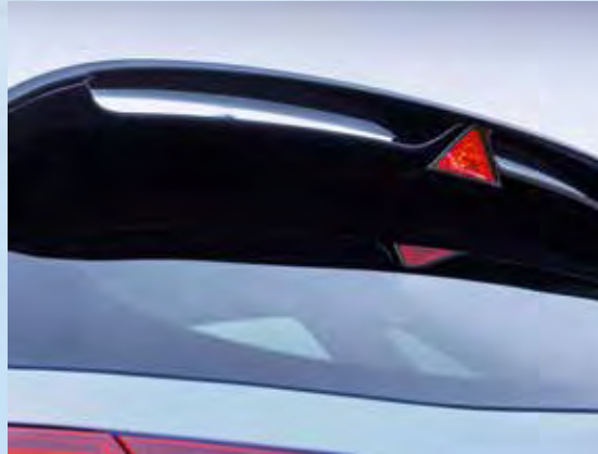
Der Heckspoiler sorgt für verringerten Auftrieb beim dynamischen Fahren.
