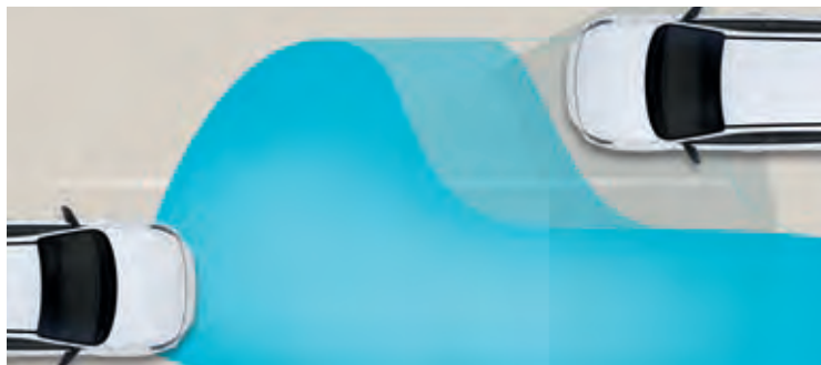
El sistema de detección de ángulo muerto (BSD) advierte al conductor de la presencia de vehículos en los ángulos muertos, por medio de alertas acústicas.
