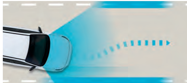
El sistema de aviso de cambio involuntario de carril advierte al conductor en caso de salida de carril y corrige la trayectoria para mantener al vehículo dentro del carril, aumentando la seguridad.
