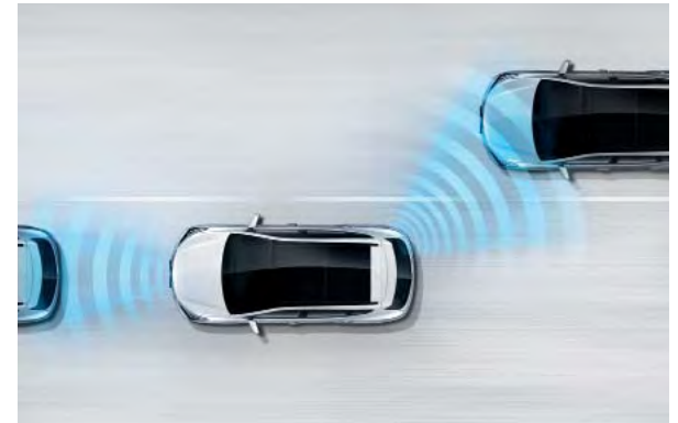
Totwinkel-Assistent 1 . Die an den Seiten am hinteren Teil des Wagens angebrachten Sensoren messen den Abstand zu Fahrzeugen im toten Winkel und lösen ggf. ein Warnlicht im Seitenspiegel aus. Bei gesetztem Blinker ertönt zusätzlich eine akustische Warnung.
