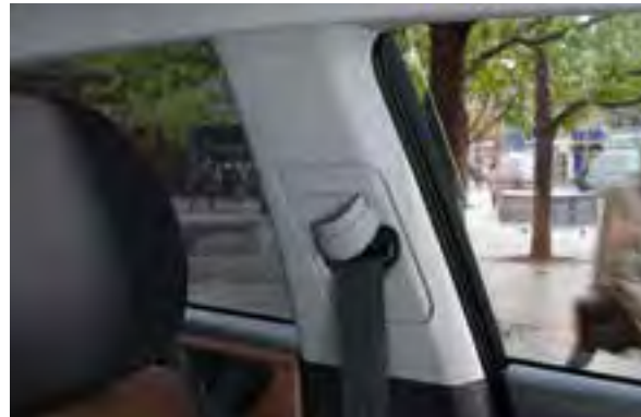
Höhenverstellbare Sicherheitsgurte 1 . Die oberen Befestigungen der Sicherheitsgurte an den Vordersitzen sind höhenverstellbar – für mehr Sicherheit und Komfort.
