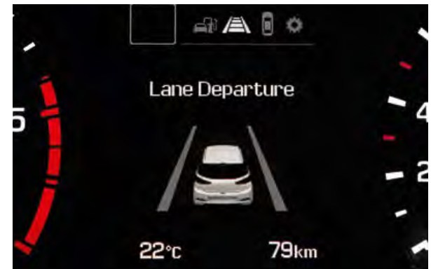
Spurhaltewarnsystem. Sollten Sie versehentlich Ihre Spur verlassen, erfolgt sofort eine sicht- und hörbare Warnung.
