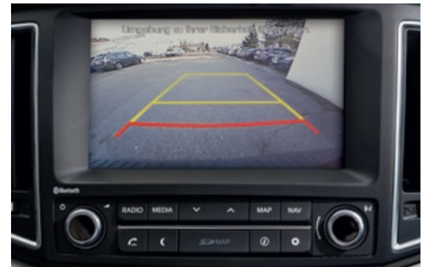
Rückfahrkamera 1 . Auch nach hinten vorausschauend. Sobald Sie den Rückwärtsgang einlegen, erscheint ein farbiges Weitwinkelkamera-Bild auf dem Bildschirm des Radio-Navigationssystems 1 .
