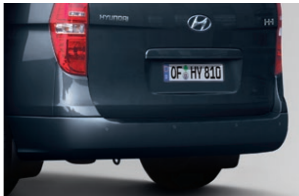
Einparkhilfe hinten 1 . Rückwärts einparken ist mit dem Hyundai H-1 Travel ein Leichtes. Sensoren im Heckbereich erfassen Hindernisse und warnen mit einem akustischen Signal.
