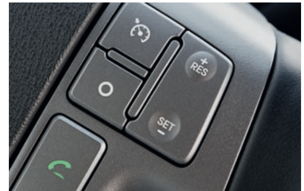
Geschwindigkeitsregelanlage. Serienmäßig bei der 5-Stufen-Automatik. Die Geschwindigkeitsregelanlage macht das Fahren besonders bei Langstrecken entspannter.
