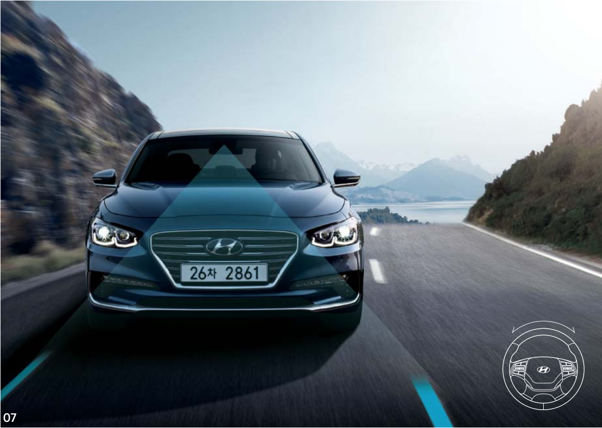
07 주행 조향보조 시스템_윈드실드 글래스 상단에 장착된 카메라를 통하여 차선을 인식하고 차선이탈이 예상되면 조향을 보조하여 차선이탈 상황을 방지해 줍니다. 차선 이탈경보 기능, 차선 유지보조 기능, 능동 조향보조 기능 중 하나를 선택하여 사용할 수 있습니다.
