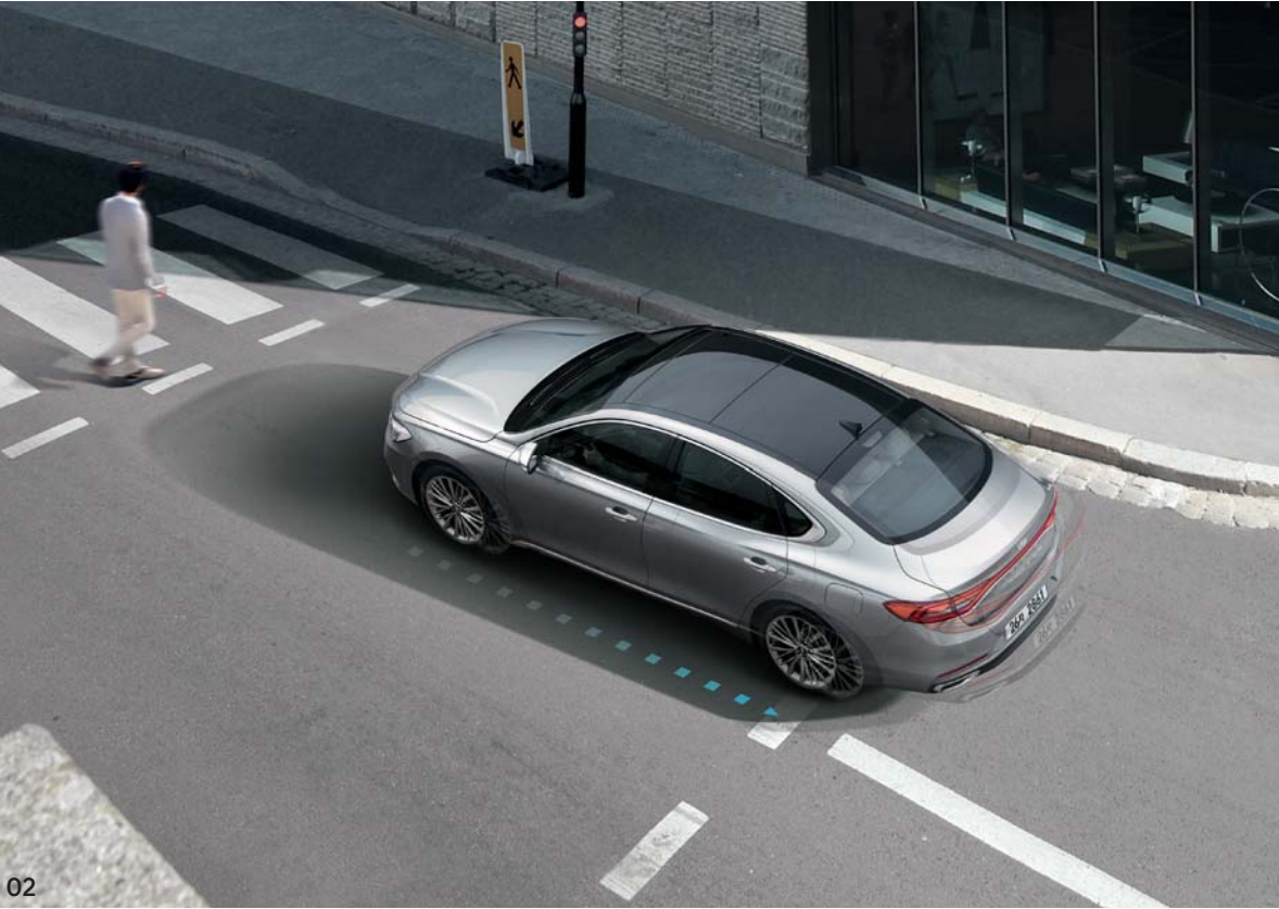
02 자동 긴급제동 시스템_전방 레이더와 전방 감지 카메라의 신호를 종합적으로 판단하여 선행 차량 및 보행자와의 충돌 위험 상황이 감지될 경우 운전자에게 이를 경고하고, 필요 시 브레이크 작동을 보조합니다.
