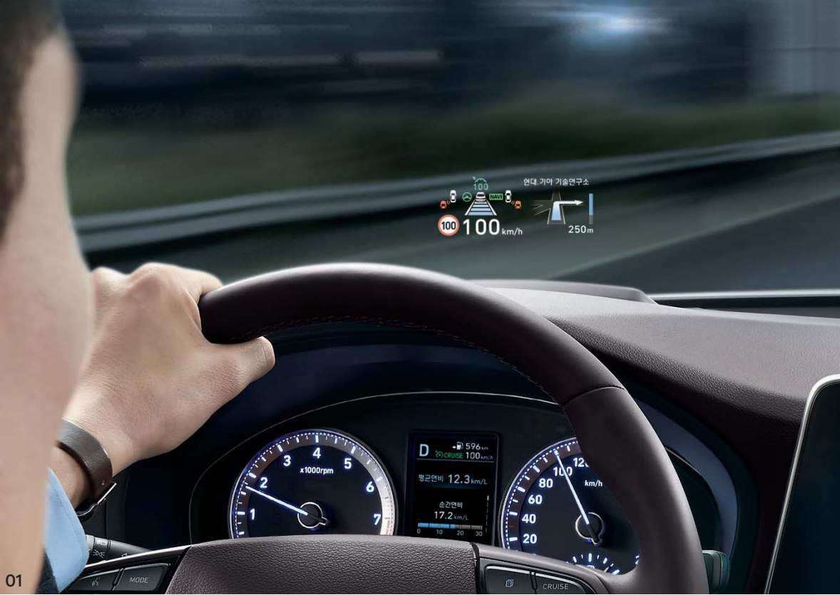
01 헤드업 디스플레이_영상 이미지의 고급화와 선명도를 향상시켰으며, 스위치 조작결과가 시각적으로 피드백되는 기능까지 적용했습니다.
