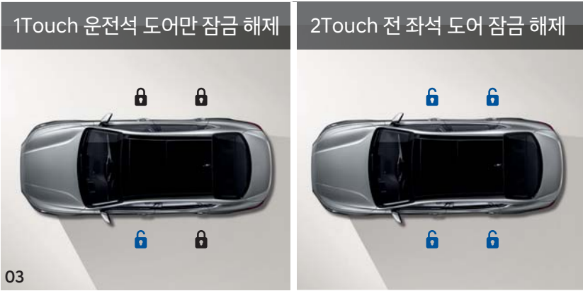
02 전동식 파킹 브레이크 (오토홀드 기능 포함)_정체구간 운전 및 경사로 정차 시 오토홀드 기능을 통해 브레이크 페달을 밟지 않아도 안전하게 정차상태를 유지해 줍니다. 03 세이프티 언락_차량 범죄 예방을 위해 도어열림 버튼을 1회 누르면 운전석 도어만 잠금 해제되며, 한번 더 누르게 되면 전 좌석의 도어가 잠금 해제되는 기능을 설정할 수 있어 여성운전자에게 더욱 안전한 드라이빙 환경을 제공합니다.
