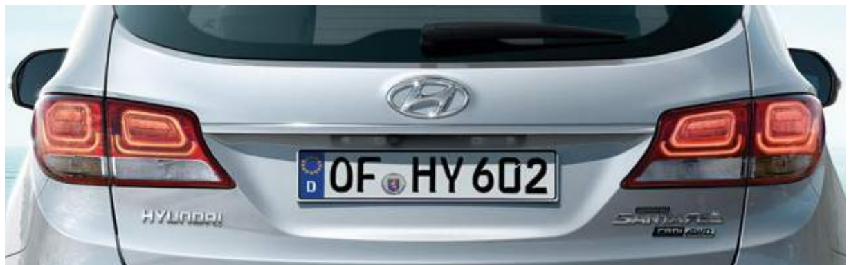
LED-Rückleuchten. Mehr als ein Designelement. Mit der Notbremsignalisierung schaltet sich bei einer Notbremsung automatisch die Warnblinkanlage ein. So können Auffahrunfälle vermieden werden.
