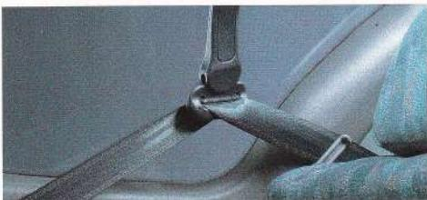
Automatikgurte hinten. Die Gurtschlösser werden an speziellen Clips festgehalten und sind somit aus dem Weg, wenn sie nicht gebraucht werden. Noch ein Wort zur breiten Heckklappe: sie lässt sich durch die außenliegenden Scharniere extrem
