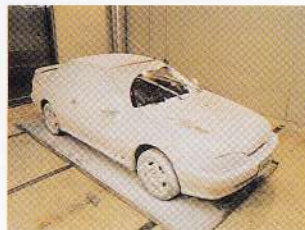
In speziellen Versuchsräumen werden die Fahrzeuge extremen Temperaturen ausgesetzt.
