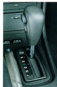
De elektronisch geregelde automatische viertraps transmissie met een lock-up systeem laat zich soepel bedienen en werkt brandstofbesparend. De trappen kunnen worden geblokkeerd, bijvoorbeeld bij bergafwaarts rijden. Een kickdown zorgt desgewenst voor de nodige acceleratie voor bijvoorbeeld een inhaalmanoeuvre.
