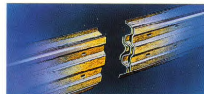
Veiligheidsbalken in de portieren verhogen de veiligheid bij aanrijdingen van opzij.
