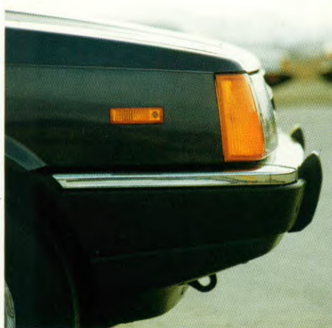
Spoiler vóór geïntegreerd met bumper.
