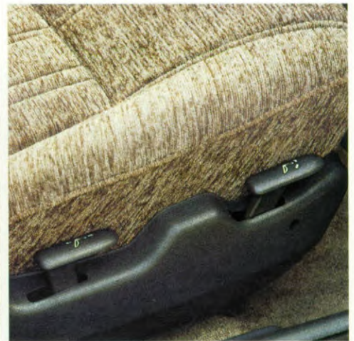
Stoelverstelling in drie richtingen (GSL).
