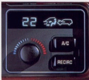
Die Klimaautomatik hält die von Ihnen eingestellte Temperatur konstant und sorgt so für ein gleichbleibend angenehmes Klima im Innenraum.
