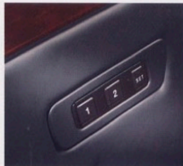
Die Memoryfunktion ermöglicht es zwei verschiedenen Fahrern, ihre persönliche Sitzposition, Außenspiegel- und Radioeinstellung zu speichern. Per Knopfdruck lassen sie sich jederzeit wieder abrufen.
