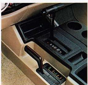
Das 4-Stufen-Automatikgetriebe hat einen lang übersetzten vierten Gang, der den Kraftstoffverbrauch reduziert.
