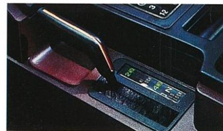
En option avec le nouveau système Selec-Trac®, un sélecteur à 5 positions au plancher, pour la conduite permanente 4RM.
