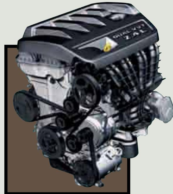
Il motore 2.4 DOHC "dual VVT" è un propulsore costruito da Global Engine Manufacturing Alliance capace di erogare con i suoi quattro cilindri quasi la stessa potenza di un motore a sei cilindri.
