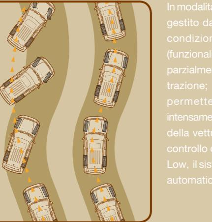
In modalità 4WD Auto, l'ESP può essere gestito dal guidatore in funzione delle condizioni di aderenza del terreno (funzionalità "3 mode"); disinerendolo parzialmente si esclude il controllo della trazione; disattivandolo totalmente si permette al guidatore di vivere intensamente le capacità fuoristradistiche della vettura. Per ottenere il completo controllo della vettura in modalità 4WD Low, il sistema ESP viene totalmente ed automaticamente disattivato.
