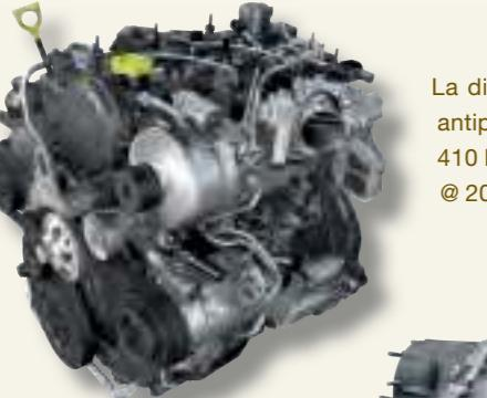
La dinamica motorizzazione 2.8 16V turbodiesel Common Rail, abbinata al filtro antiparticolato di serie, eroga una potenza di 177 CV @ 3800 giri/min e una coppia di 410 Nm @ 2000-2800 giri/min con la trasmissione manuale a 6 rapporti e di 460 Nm @ 2000 giri/min con quella automatica a 5 velocità.
