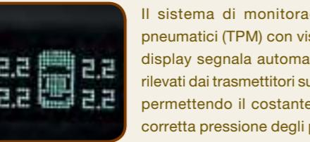
Il sistema di monitoraggio pressione pneumatici (TPM) con visualizzazione su display segnala automaticamente i dati rilevati dai trasmettitori su ciascuna ruota, permettendo il costante controllo della corretta pressione degli pneumatici.
