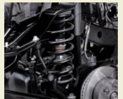
La Suspensión Quadra-Coil utiliza amortiguadores de gas para ayudarle a mantener los neumáticos en contacto con la superficie.
