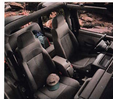
Opěrky hlavy a výztuhy opěradel chrání řidiče i spolujezdce při nárazech způsobených nerovnostmi terénu.
