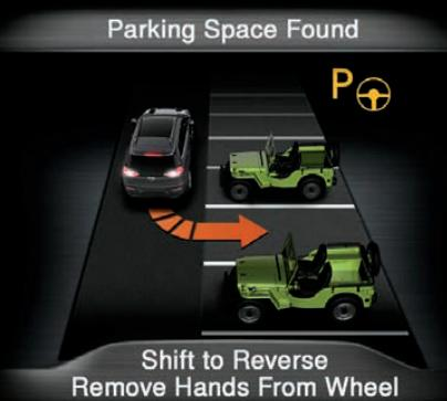
Der optionale Parkassistent für Längs- und Querparken wird in der Mitte der Instrumententafel angezeigt und hilft dem Fahrer des Jeep® Cherokee zuverlässig beim Parken.
